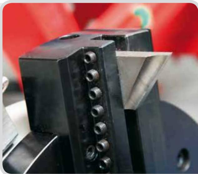
L'unità può utilizzare utensili facilmente intercambiabili per la realizzazione di smussi di qualsiasi forma e angolazione. In relazione al materiale da lavorare sono disponibili in diverse tipologie:
